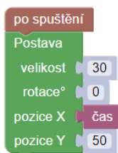
Obr. č. 3: Použití proměnné čas jako parametru polohy objektu v programu.
